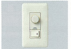
NOF20874 氣氛開關B(單切)(白熾燈燈光控制)(旋轉式) (附蓋板)800W 220V AC
